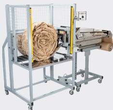
Le **Coiler** est une solution destinée à être utilisée en conjonction avec le système Packmaster™ Pro. Il permet la production automatique d'escargots de papier.
