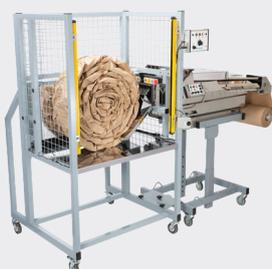
El **Coiler** es una solución atornillada diseñada para ser usada en conjunto con el sistema Packmaster™ Pro Fanfold para automatizar el proceso de producción de grandes cantidades de bobinas de papel de alta protección.
